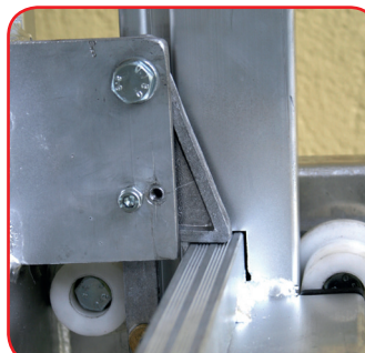
Gancio automatico sostegno piattaforma
