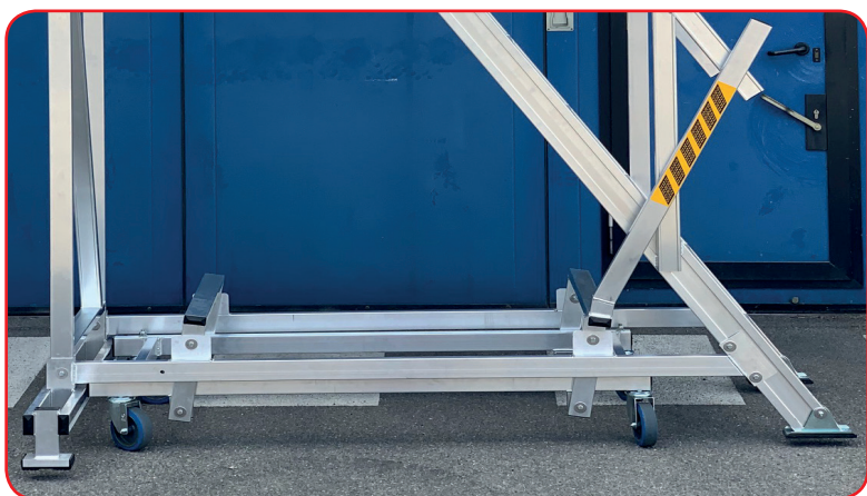
Sicurblock disattivato con ruote attive e scala spostabile con i piedi sollevati da terra
