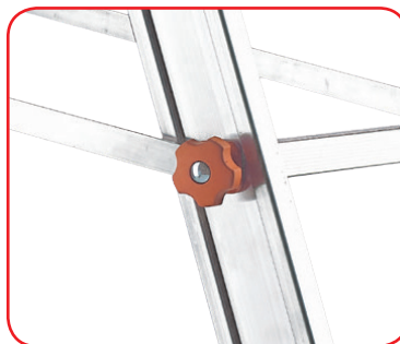
Dispositivo anti-ribaltamento del terzo tronco (Luxe3) Impedisce che il terzo tronco sfugga di mano e cada mentre lo si sfilava in posizione a cavalletto.
