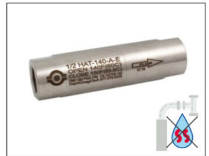
ISC9092 Kit anti-scald per lavaocchi. Previene il surriscaldamento dell'acqua. Una valvola termostatica apre il circuito a 40°C e lo chiude quando l'acqua torna sotto i 35°C. Misura 1/2".
