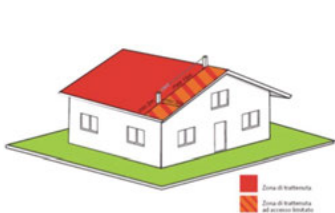
Esempio di applicazione: risalita in trattenuta su copertura a due falde
